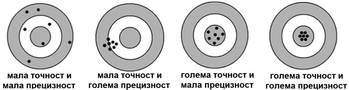
Слика 1.29. Разлика меѓу точност и прецизност на систем
