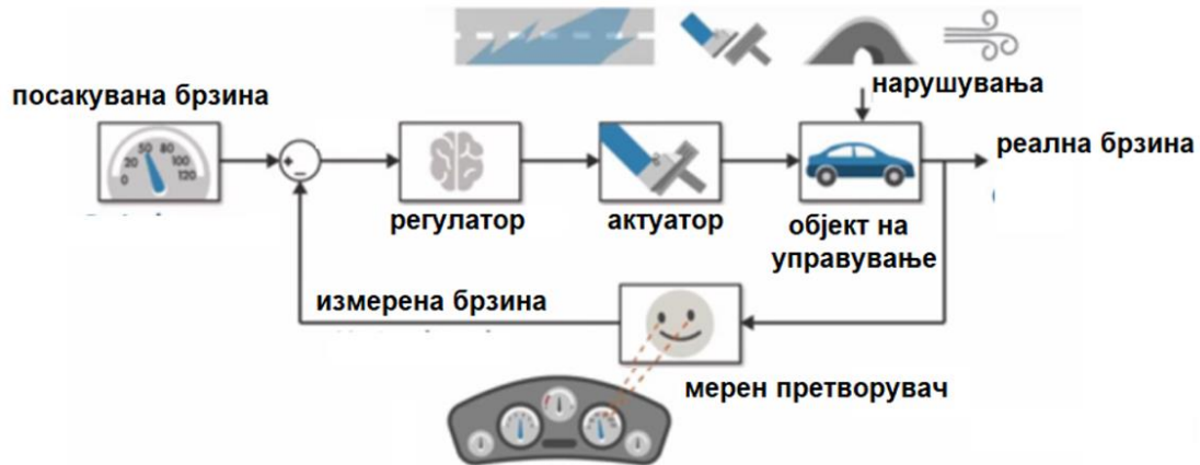
Слика 1.26. Управувањето со брзината е затворен систем
