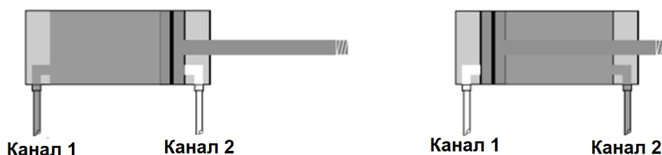
Слика 3.14. Принцип на работа на хидрауличен детектор на сигнал на грешка
