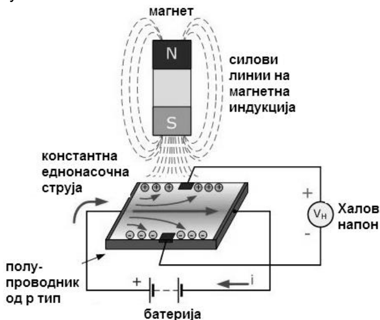
Слика 2.40. Принцип на работа на Халов сензор
