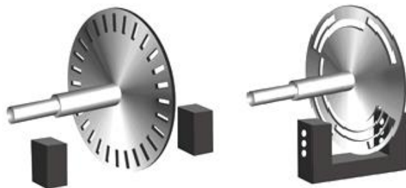
Слика 2.35. Споредба меѓу инкрементирачки и апсолутен кодер
